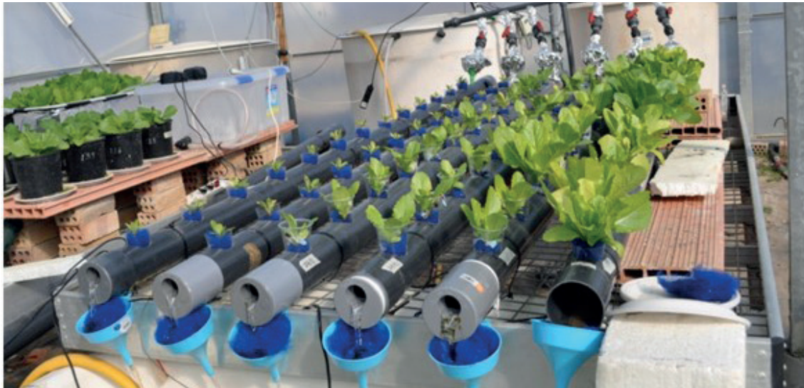
N.F.T. de tuberías horizontales en instalaciones de ETSIA, Universidad de Sevilla / N.F.T. horizontal pipe system in ETSIA facilities, University Seville
