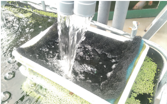
Filtración mecánica con esponjas / Mechanical filtration using sponges
